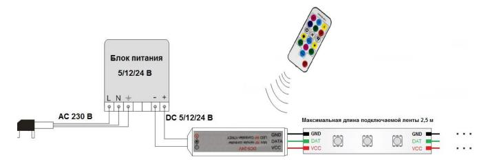
к контактам **«GND»** / **«DAT»** / **«VCC»** на клеммнике прибора подключите соответствующие линии связи от нагрузок. Максимальная длина подключаемой ленты — 2,5 м.
