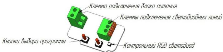
Рис.1 Назначение органов управления и индикации
