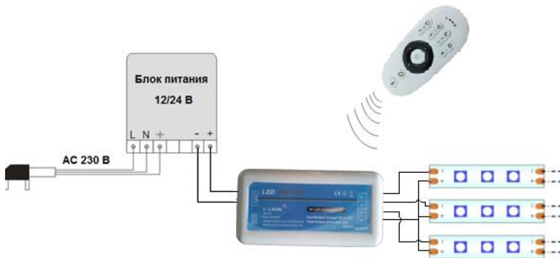
1. Схема подключения диммера
