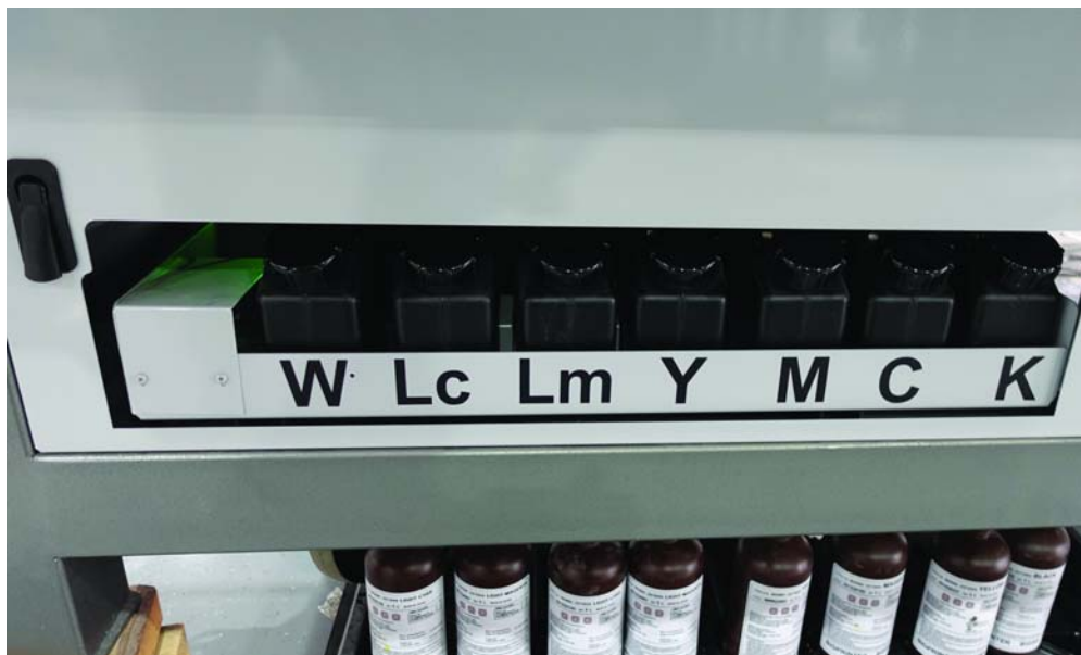
Картриджи с краской вынесены на переднюю панель для экономии рабочего пространства
