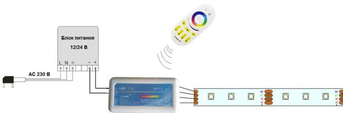
1. Схема подключения контроллера
