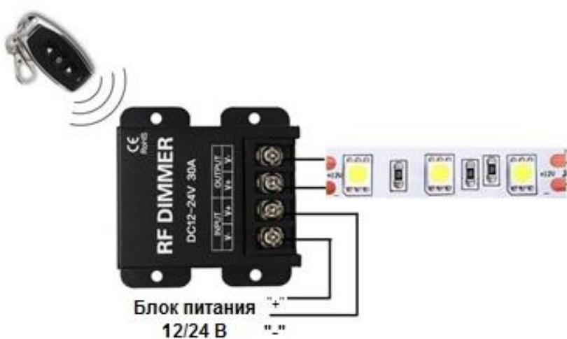
к контактам «+» и «-» на клеммнике прибора (OUTPUT) подключите соответствующие линии связи от нагрузок.
