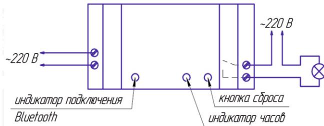
В рабочем состоянии индикатор подключения Bluetooth мигает медленно (1 Гц). Двойное мигание в секунду (2 Гц) - автореле подключено к смартфону или планшету.
