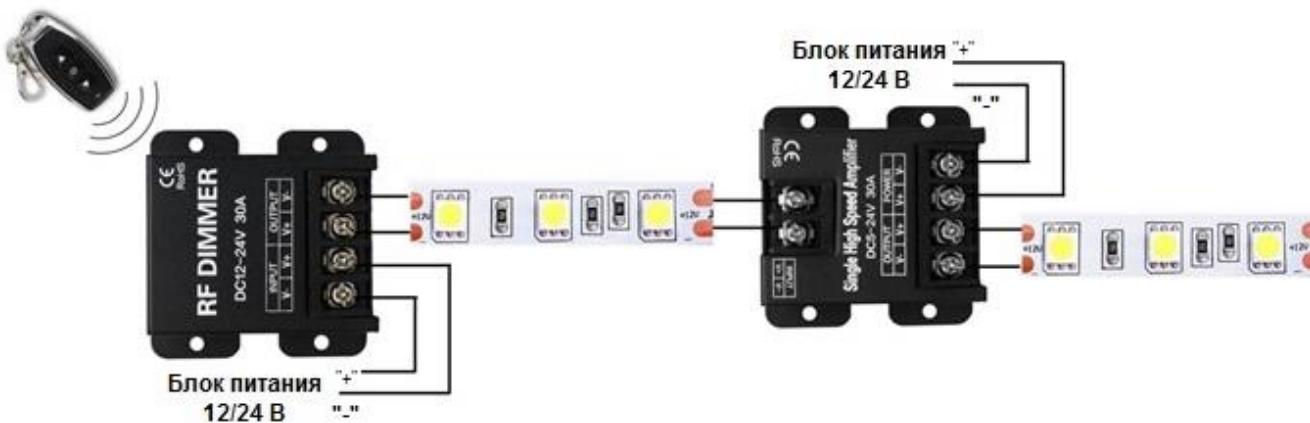
к контактам «+» и «-» на клеммнике прибора (OUTPUT) подключите соответствующие линии связи от нагрузок.
