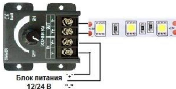
к контактам «+» и «-» на клеммнике прибора (OUTPUT) подключите соответствующие линии связи от нагрузок.
